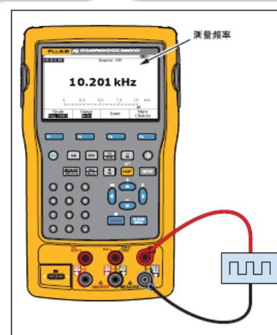
转速计检查/频率测试
