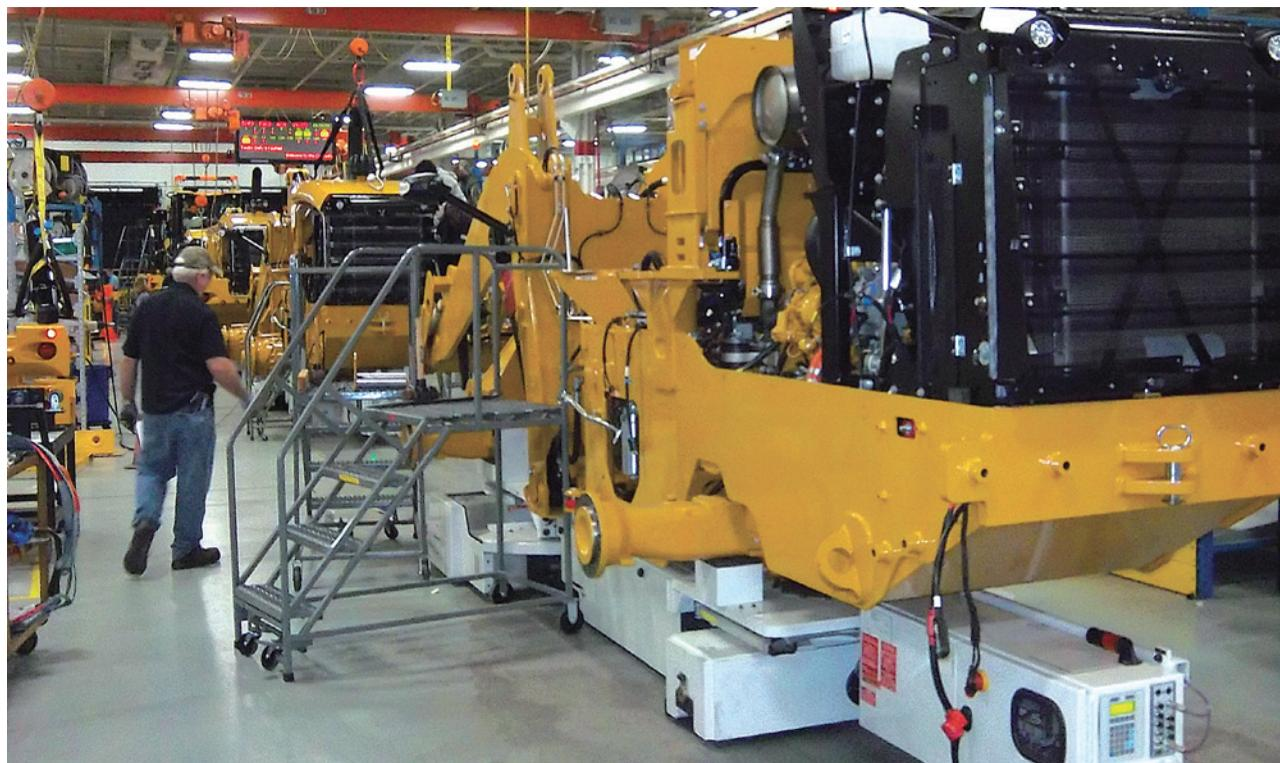
相比于更加传统的移动流水线,如果使用无电池的AGV,装配流水线可以运行得更加快速。Superior Controls公司指出,感应电力传输技术可应用于传送较重的负载。
