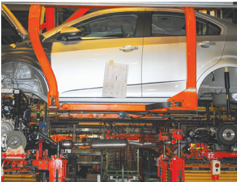
自动导引车辆的液压系统可以将汽车抬升到适当的高度，以改善装配工人在装配作业时的人体工程学。
