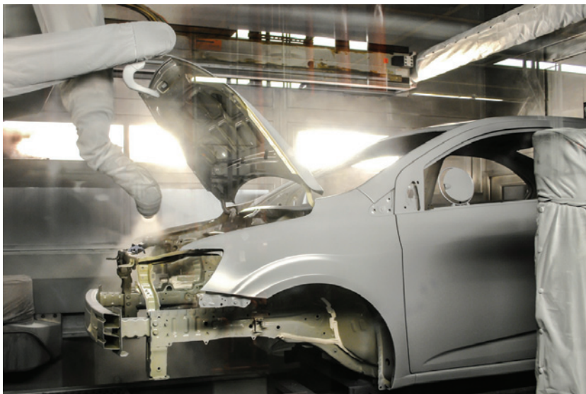
对 Orion 工厂投资的一部分用来建立了一个新的喷涂车间，这个新的喷涂车间将原来的三道工序转换合并成一道工序，新喷涂车间的占地面积也比原来减少了。
