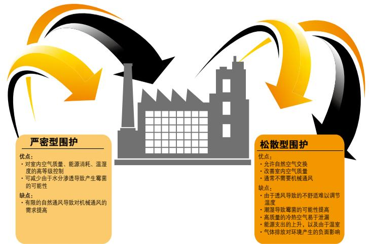
图3：建筑物围护结构功能。资料来源：Allied Reliability
