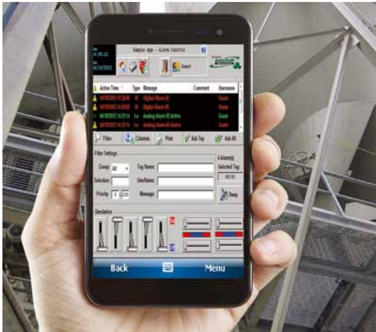
种报警管理系统应该包含实现以下这些功能的工具，包括但不限于：可自主配置的报警限制、报警显示、以及，最重要的是，过滤器。
