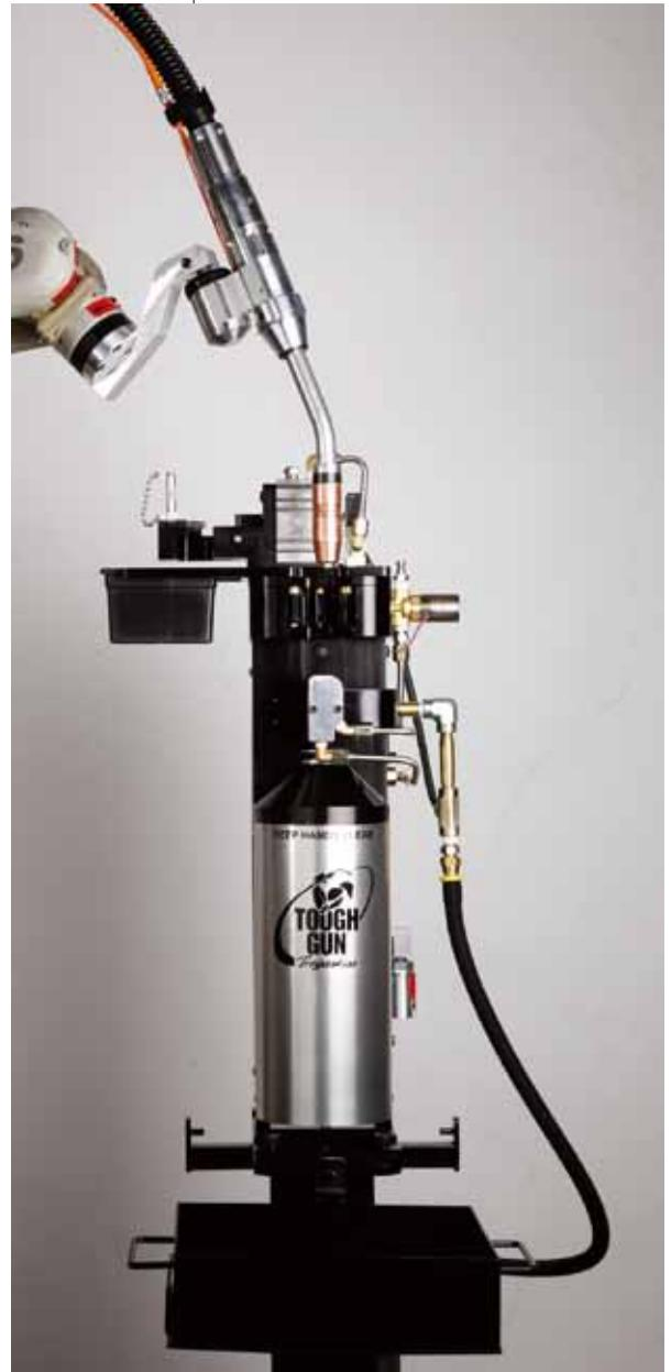
拥有一个正常工作的铰刀可以延长耗材的使用寿命，这一设备发生任何问题时，都应检查铰刀的位置是否正常，且是否能够正常供应防飞溅剂。
