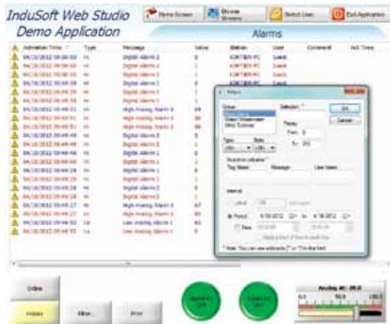
图3：通过在过滤器对话框中填写一个字段，用户就可以在系统运行时触发同一对话框，或者根据操作状态来改变对话框。资料来源：Indusoft
