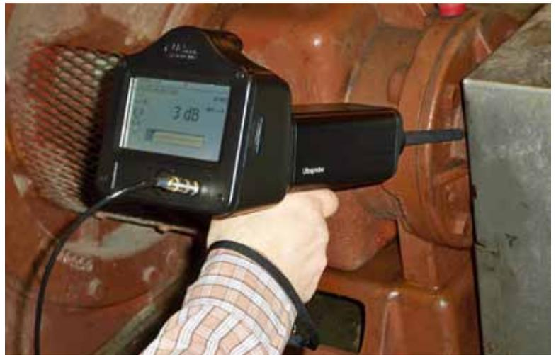
对内部疲劳的测试和检测以防止轴承发生故障是非常重要的，这可以避免昂贵的停机维修。
