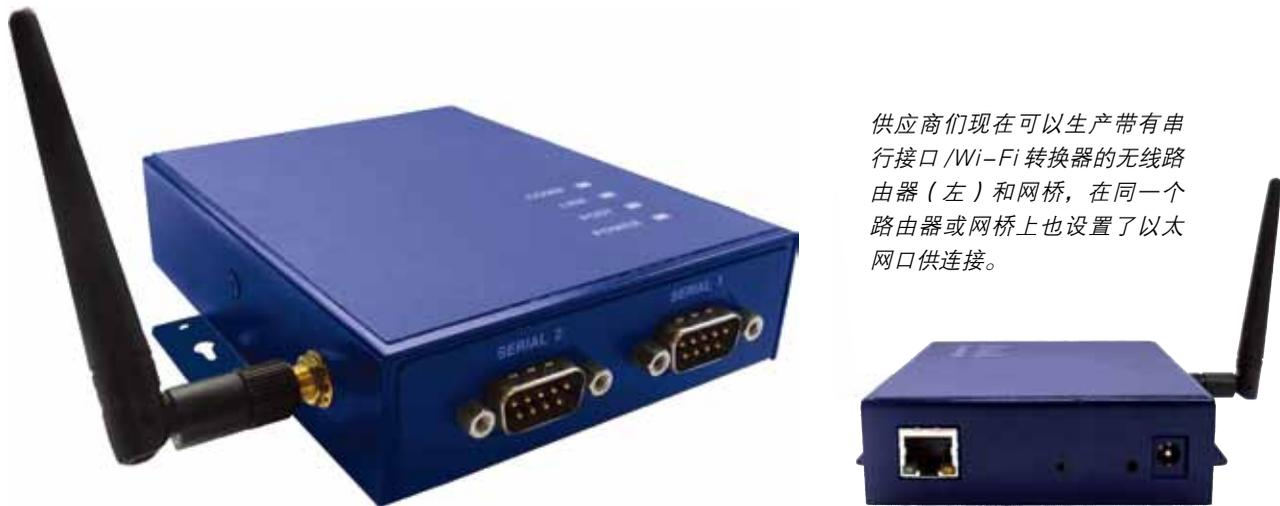
供应商们现在可以生产带有串行接口/Wi-Fi 转换器的无线路由器（左）和网桥，在同一个路由器或网桥上设置了以太网口供连接。
